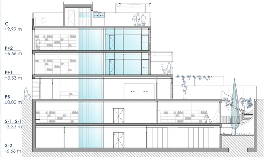
SECCIÓN LONGITUDINAL SECCIONES Y ALZADOS E:1/150
